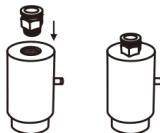
Draai de connector op de diffuser.
